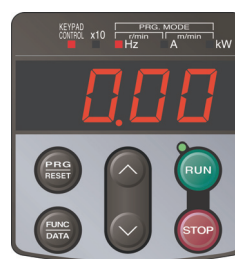
圖 4.3 供應電源時的 LED 監視顯示內容
