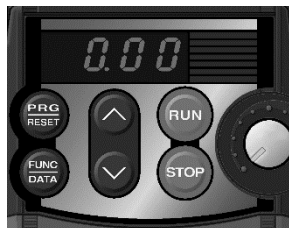
图 4.2 电源接通时的 LED 监视器表示
