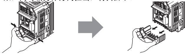
图 3.7 下部外罩的拆卸方法（柜内安装型）
