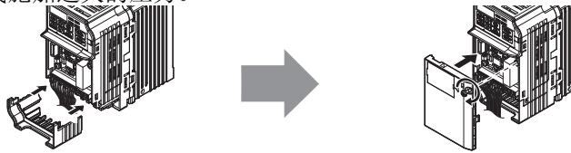
图 3.8 保护罩的安装方法（柜内安装型）
