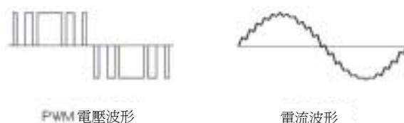
圖 1.23 變頻器輸出電壓·電流波形
